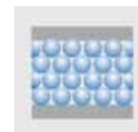
Ułożenie konwencjonalnych kulek styropianowych bez próżni
